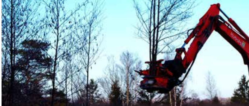
Baumfällung mit Harvester: der Baum wird gegriffen, abgeschnitten und aus dem Bestand herausgehoben.
