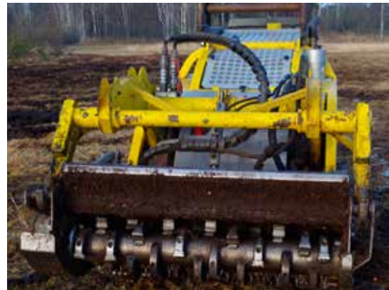
Forstmulcher, mit diesem Gerät werden Äste und kleine Wurzelstöcke zerkleinert und der Boden eingeebnet.
